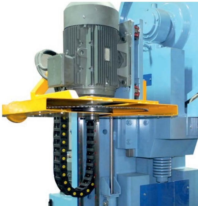
• Fİ.100 – 120 – 140 / HDG TOMRUK BİÇKİSİ ile entegre edilen yatay daire kesim sistemidir.
